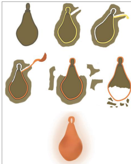
Proceso de manufactura de cascabeles de cobre siguiendo la técnica de la cera perdida.
