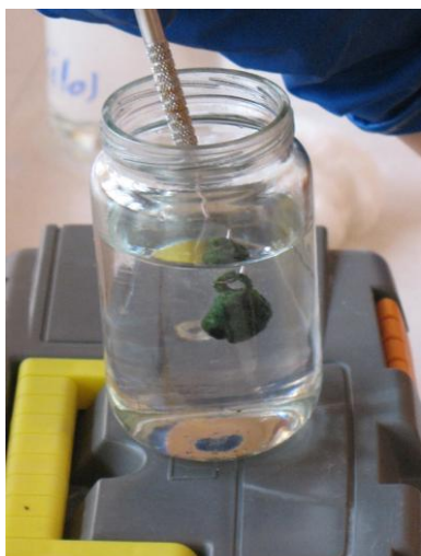
Inmersión en la mezcla de Paraloid B-72 y Benzotriazol. Proceso de secado de las piezas al aire libre.
